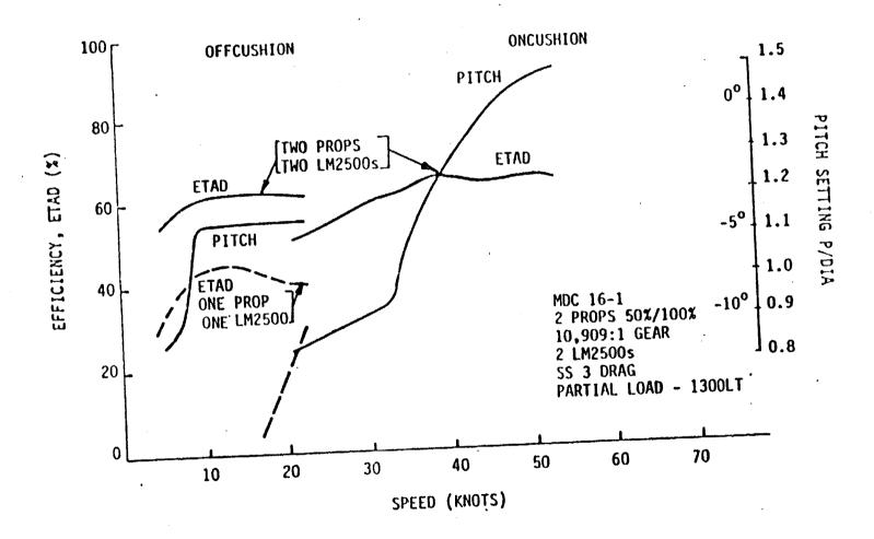
Figure 1-5 PROPULSIVE EFFICIENCY VERSUS SPEED
