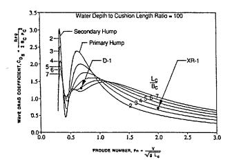
Figure 3-2. Cushion Wave-Drag Parameter Versus Froude Number
